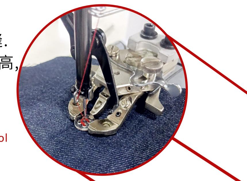
标配了几十种不同的缝制花样,切换简单,从而轻松应对 各种纽扣的缝制规格.
