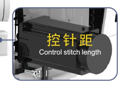
③ 步进电机调针距:针距准确,设定值即实际值;线迹重合精准,加固线迹漂亮,能进行装饰线迹的缝纫,倒缝声音轻。
