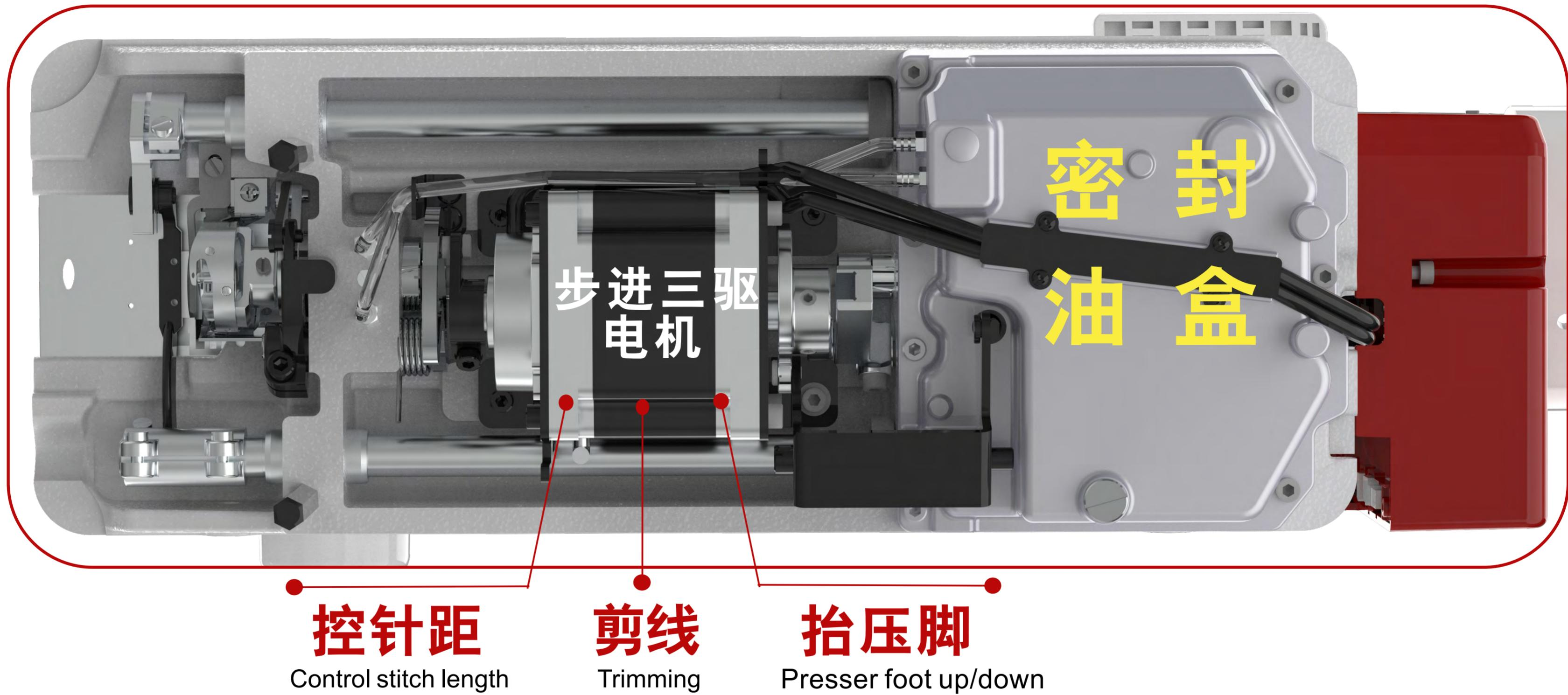
**步进三驱专利技术实现颠覆式革新，由一个步进电机控制针距、剪线以及抬压脚功能，精准控制针距，剪线无声，抬压脚不费力，品质好，更稳定！**
