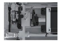
步进电机控制剪线机构:剪线稳定声音轻
